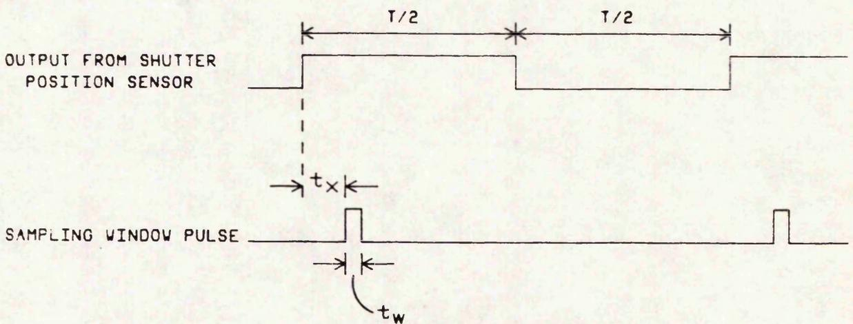
DIAGRAM SHOWING THE SIGNALS USED FOR ION ARRIVAL DATA ACQUISITION USING A TIME WINDOW EQUAL TO 6.4  $\mu\text{s}$
