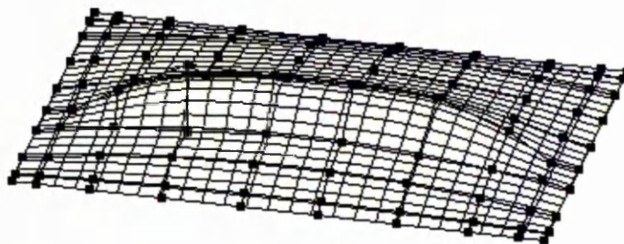
(d) The surface after knot removal ( 10 \times 10 control points)
